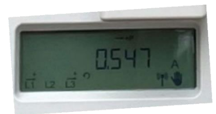
Figur 1: Dette er ein jordfeil, stor feil, viser tall over 0.000 A.
